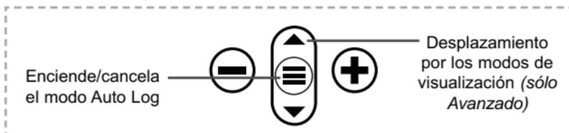
**Los modelos Estándar** quedarán encendidos durante el modo Auto Log. El equipo realizará lecturas durante unas 50-60 horas con pilas alcalinas, dependiendo de la frecuencia de medición.
