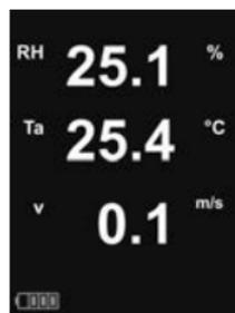
**NOTA:** El punto de rocío (Td) y la temperatura de superficie (Ts) no se mostrarán si el **anemómetro** está encendido.
